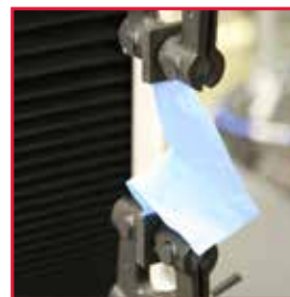
Tear Testing EN 388-16
